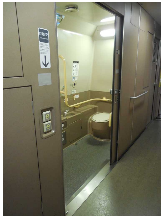
E 1 3 編成の 7 号車の車いす対応トイレ。 ベビーチェア・ベビーベッドのいずれも設置されていない。
