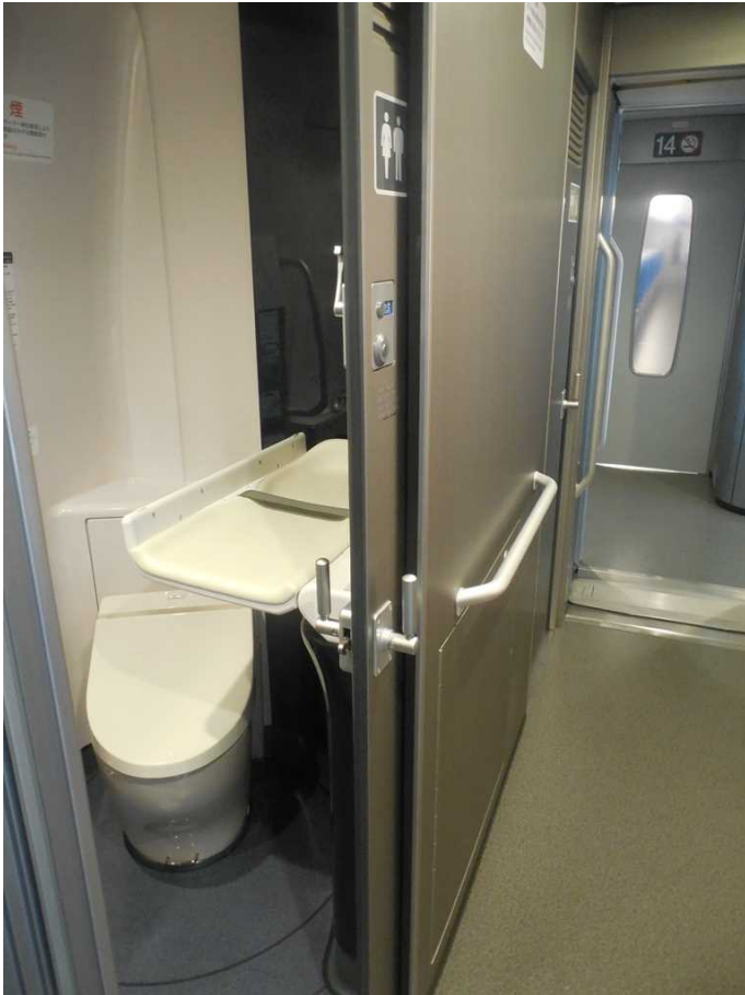
J 7 編成の 1 3 号車のトイレのベビーベッド。 2 つ並んでいるトイレのうちの 1 3 号車側に設置。 右の写真で示すベビーチェアは 奥に見えるもう 1 つのトイレに設置。
