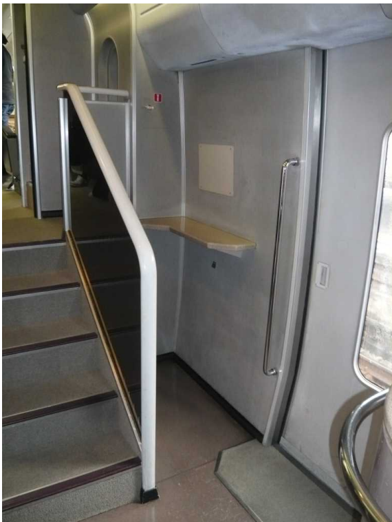
J R 東海 3 7 1 系の 3 号車の 公衆電話撤去跡
