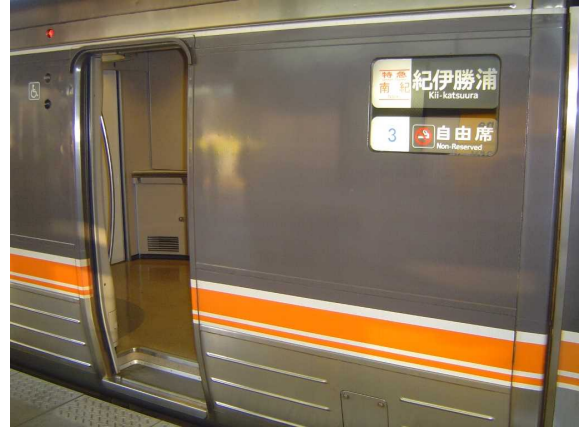
キハ85系の車いす対応座席付車両 左上の車いすマークと 乗降口のステップ(段差)に注意
