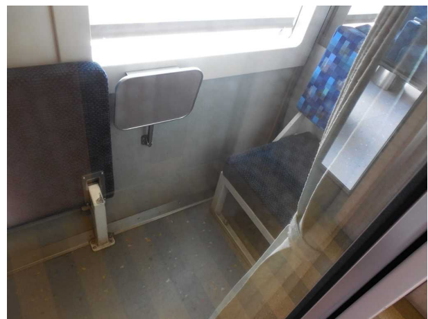
J R東日本E 2 5 7系5 0 0代の 多目的室の内部を窓越しに撮影 座面と背もたれを手前に引き出し 跳ね上げ式のいすと組み合わせると 簡易ベッドになる構造は 他の車両でも見かけるが E 2 5 7系では簡易ベッドの寸法が小さい
