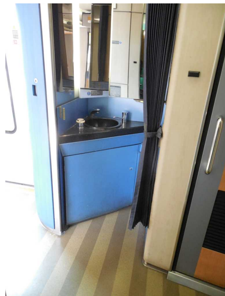
J R東日本E 2 5 7系5 0 0代の 3号車の車いす非対応洗面所 5号車の洗面所も同じ構造
