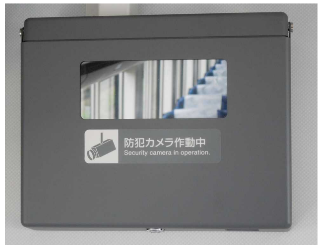
J R東日本E 2 5 7系5 0 0代の 車いす対応座席付近に設置されている 防犯カメラ
