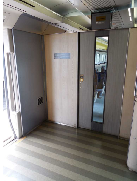
J R東日本E 2 5 7系5 0 0代の3号車の 設計時点では飲料自動販売機を 設置予定だったと思われる区画 壁の右下にコンセント設置用らしき穴を 塞いでいる小さな板がある 画面右が左の写真の公衆電話撤去跡
