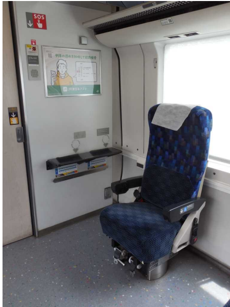
J R東日本E 2 5 7系5 0 0代の 車いす対応座席 左上に非常通話装置が見えるが 車いすの人の手が届く高さではない
