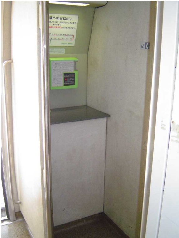
E351系の公衆電話（現在は撤去） 間口が狭く電話機の取付位置も高いため 車いすの人は利用できなかった
