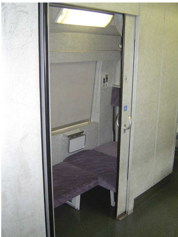
E351系の多目的室の多目的室の内部 座面を引き出し簡易ベッドを仕立てた状態 内部構造も255系の多目的室と同じ
