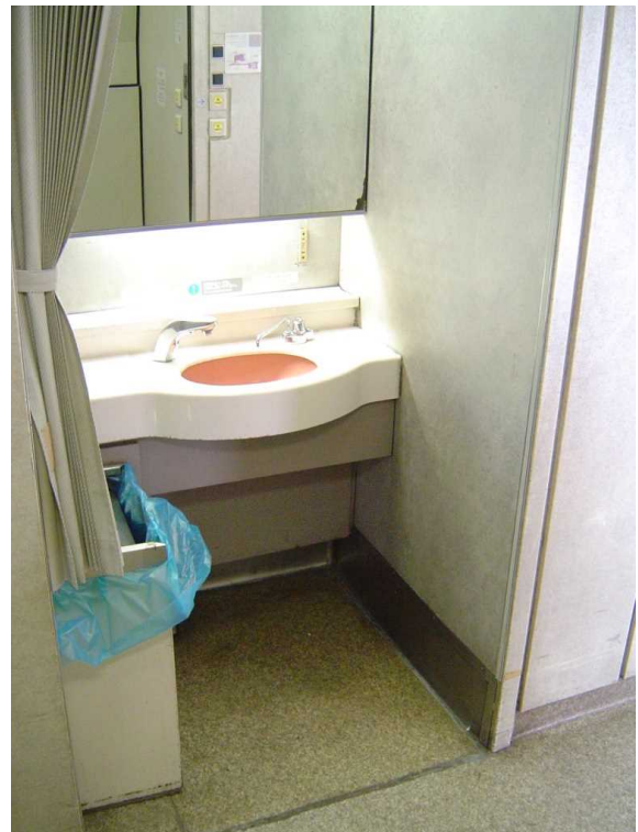
E351系の洗面所 車いすの幅によっては 左側のゴミ箱が邪魔になる可能性も
