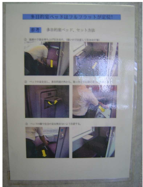
E351系の多目的室内に掲出されていた 簡易ベッドの仕立て方の説明図
