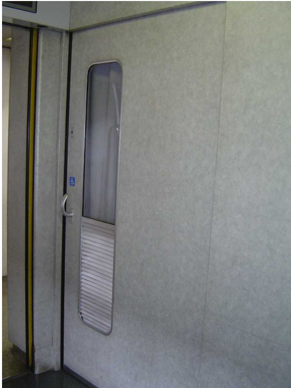
E351系の多目的室の外観 デッキではなく客室内(車いす対応座席の 向かい)に配置した独特の設計は 同時期に製造された255系と共通
