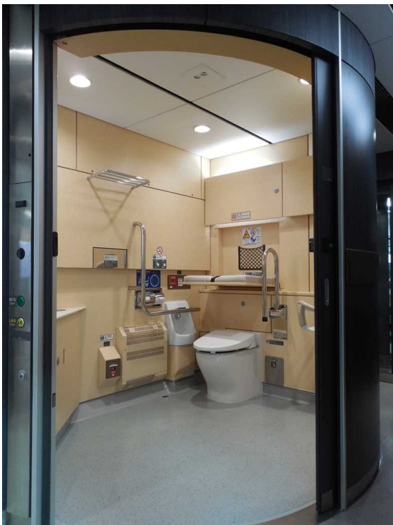
E353系の9号車の多機能トイレ 天井には喫煙感知装置が見える
