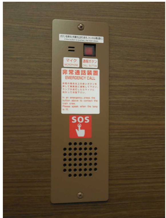
E657系の非常通話装置 車いす対応座席付近のもの以外は 立った大人の顔の高さに設置されている
