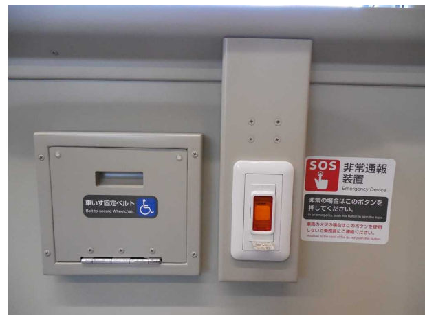
キハ261系の車いす固定ベルトと 非常通報装置
