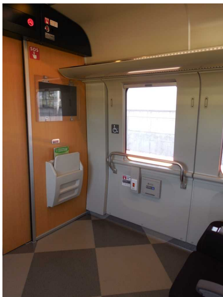
キハ261系の車いすスペース 窓の下に車いす固定ベルトと非常通報装置
