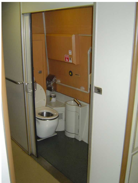
J R 四 国 8 0 0 0 系 の 車 い す 対 応 ト イ レ
