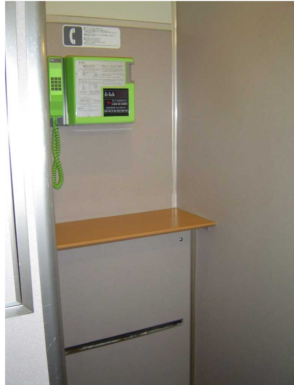
サンライズエクスプレスの3号車に 設置されていた公衆電話（現在は撤去） 間口が狭く電話機の取付位置も高いため 車いすでの利用はできなかった
