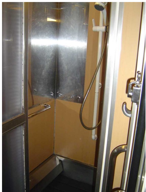
サンライズエクスプレス3号車の シャワー室 間口が狭く車いすでは利用できない
