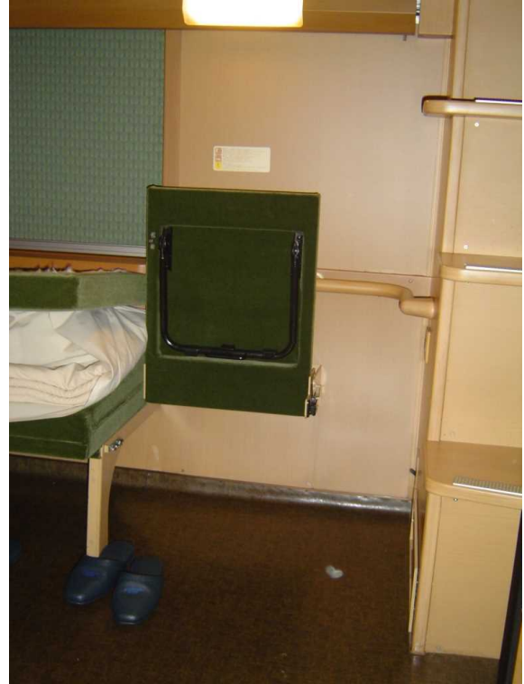
ベッドの一部を跳ね上げ車いすのまま 入室できるスペースを作った状態 介助者は右の階段から上段ベッドを利用
