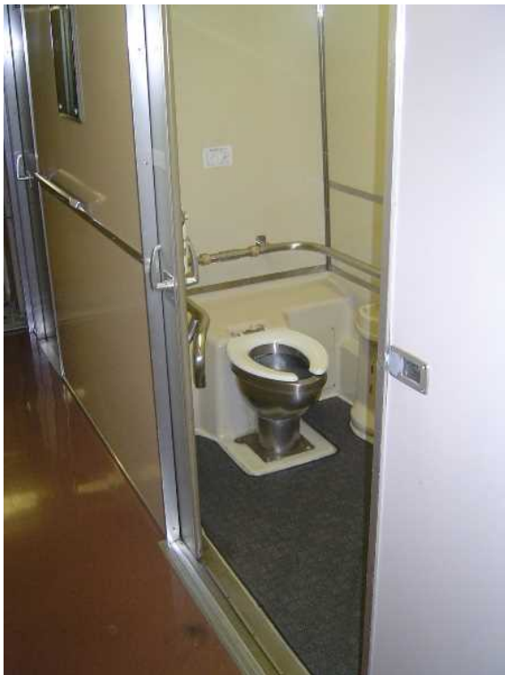
0系3号車の車いす対応トイレ （ベビーベッドなどの多機能設備は無し）
