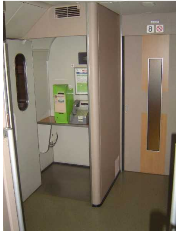
700系（レールスター） 8号車の車いす対応電話室
