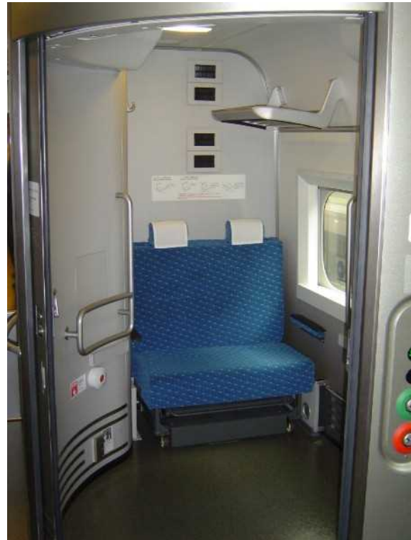
N700系11号車の多目的室の内部 （許可を得て撮影）
