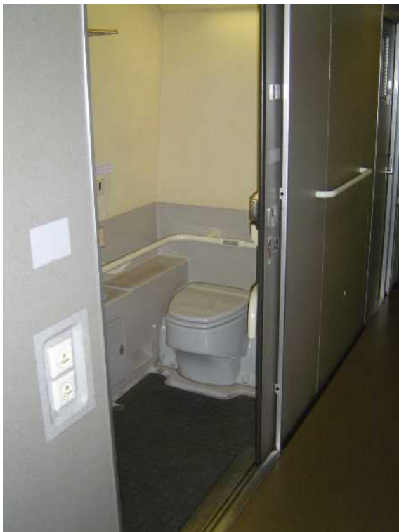
300系11号車の車いす対応トイレ （ベビーベッドなどの多機能設備は無し）
