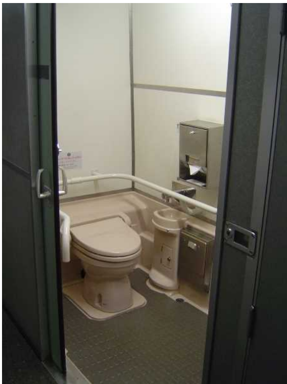
200系7号車の車いす対応トイレ （ベビーベッドなどの多機能設備は無し）
