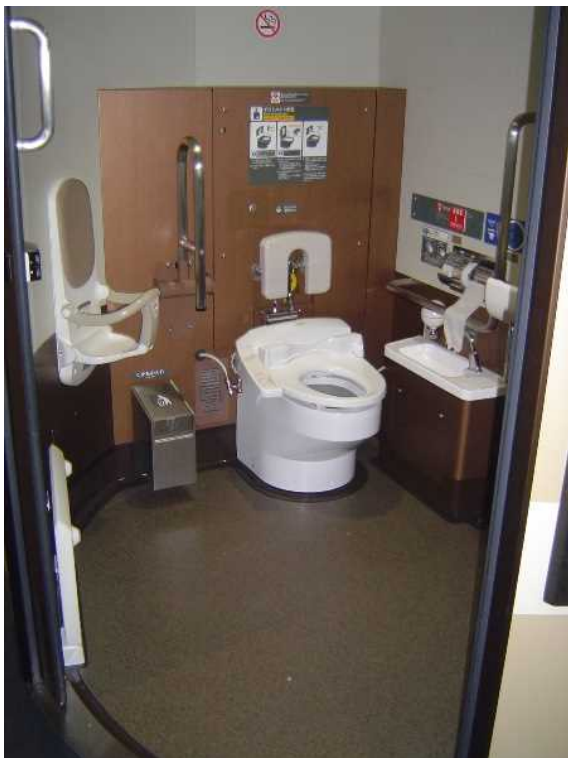
E6系11号車の多機能トイレ （おむつ交換台・オストメイト対応設備有）
