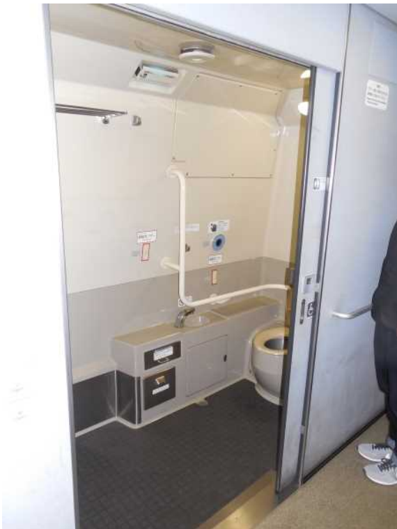
700系11号車の車いす対応トイレ （ベビーベッドなどの多機能設備は無し）
