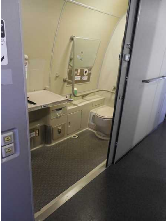
500系7号車の多機能トイレ
