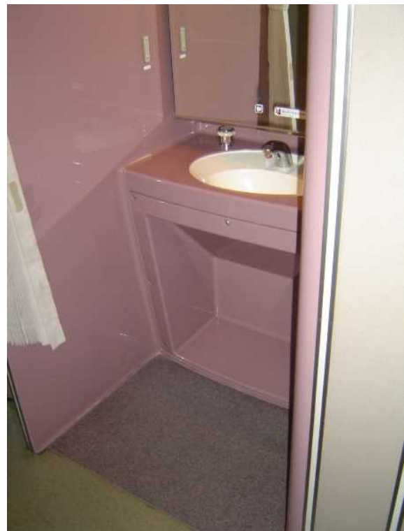
700系（レールスター） 7号車の車いす対応洗面所
