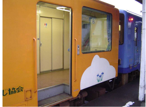
秋田内陸縦貫鉄道AN-2001号の 車いすスペース部分を車外から見た様子 乗降口のステップ(段差)にも注意
