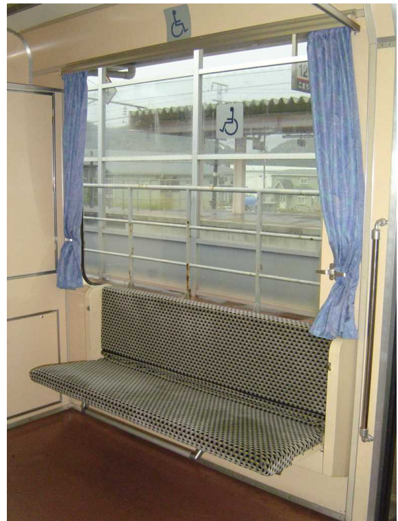
秋田内陸縦貫鉄道AN-2001号の 車いすスペース部分の折り畳み座席 体調が悪い人が横になることも可能
