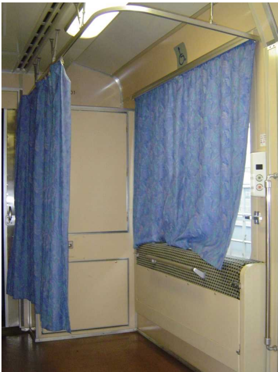
秋田内陸縦貫鉄道AN-2001号の 車いすスペース 目隠し用のカーテンも設置されている
