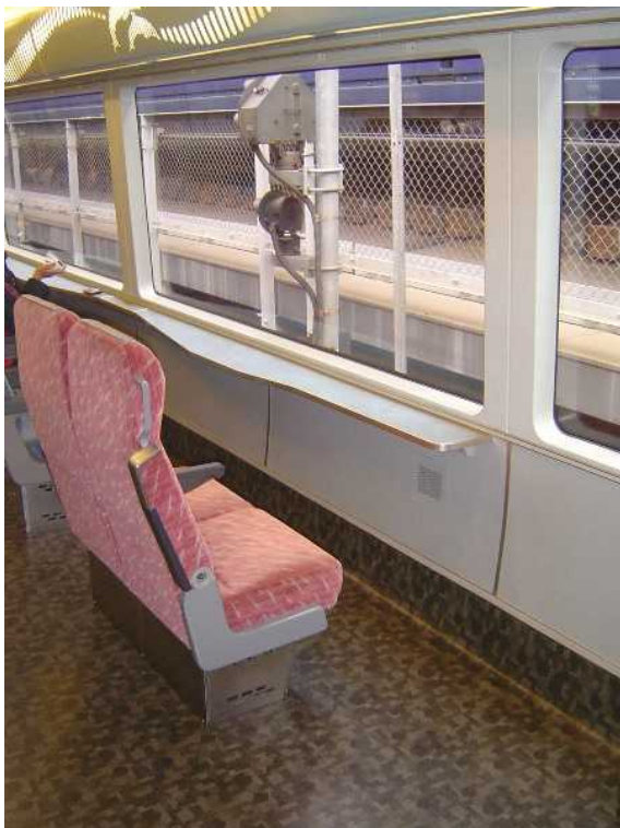
伊豆急行2100系「アルファ・リゾート21」 編成の車いす対応座席 車いす固定ベルトは付いていない
