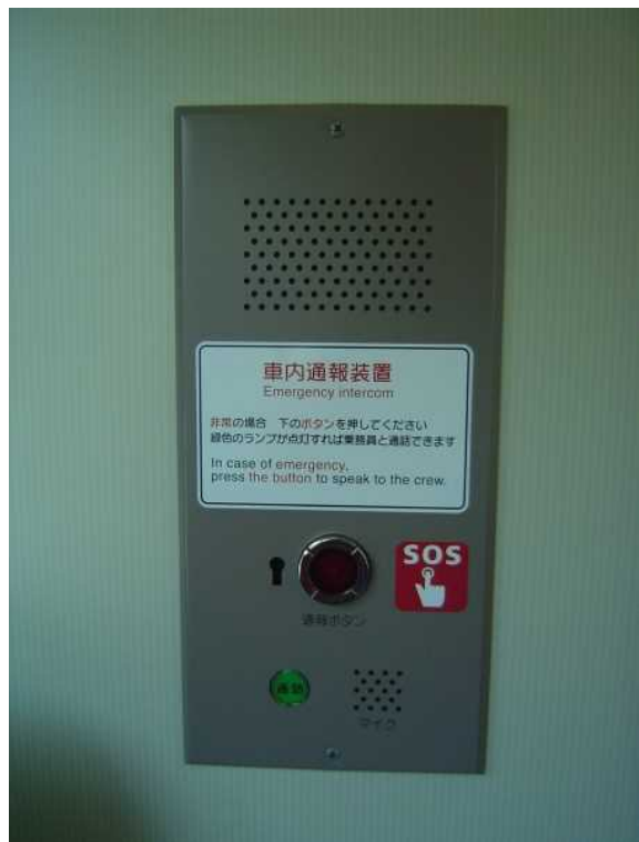
近鉄22600系「Ace」の 車いす対応座席の壁側に設置された インターホン式の車内通報装置
