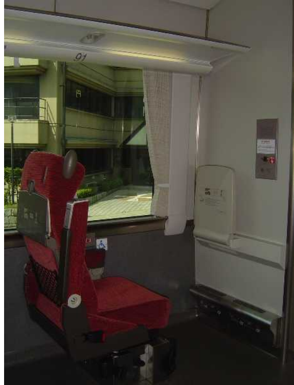
近鉄22600系「Ace」の車いす対応座席 窓の下には非常呼び出し用ブザーの押しボタンも見える
