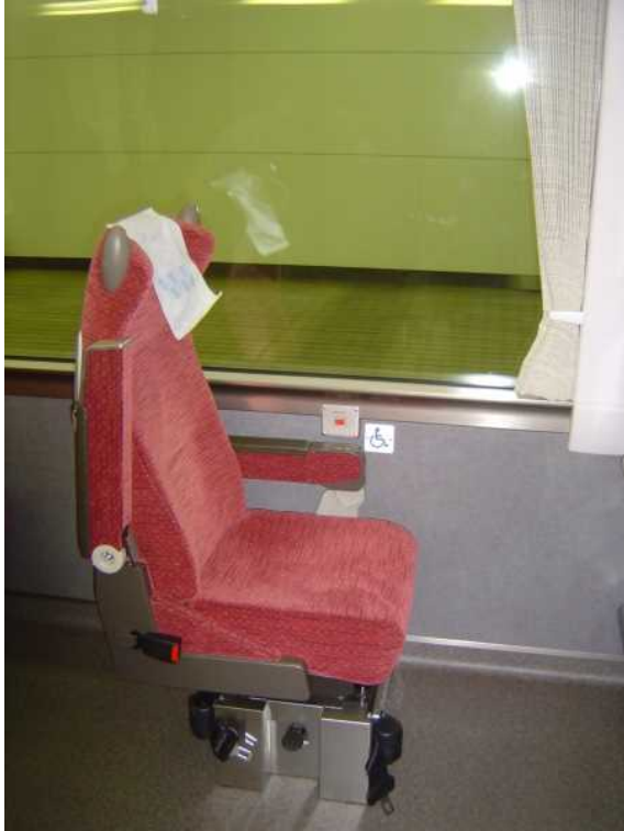
近鉄22600系「Ace」の車いす対応座席 窓の下には非常呼び出し用ブザーの押しボタンも見える
