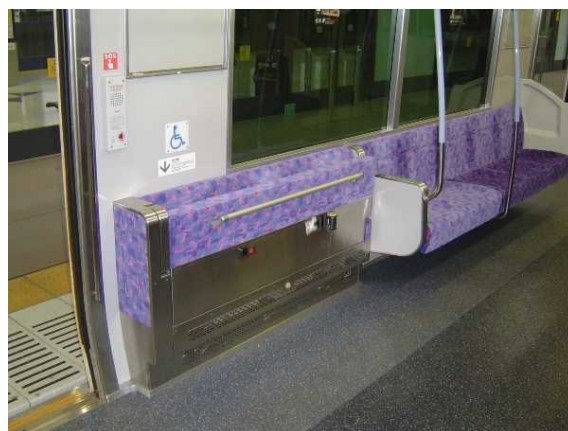
左の写真から腰掛を跳ね上げ 車いすスペースとした状態。 車椅子固定用のベルトも見える。
