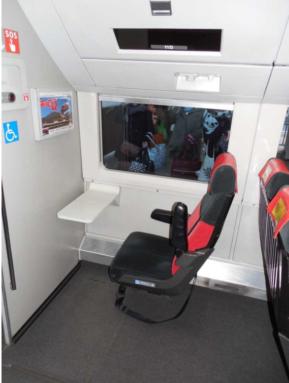
長野電鉄2100系「スノーモンキー」の 車いす対応座席 左上に見える非常通報ボタンは 車いすの人には手が届かない高さ
