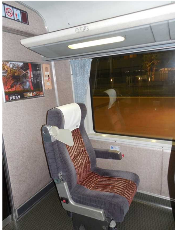
小田急電鉄30000形「EXE」の 8号車の車いす対応座席 背後の壁に非常通報器が見えるが 車いすの人には届かない高さ
