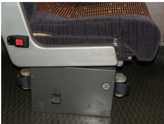
小田急電鉄30000形「EXE」の 8号車の車いす対応座席の 車いす固定ベルト
