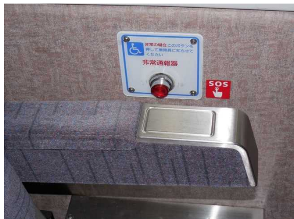
小田急電鉄30000形「EXE」の 8号車の車いす対応座席の窓下にある 非常通報器
