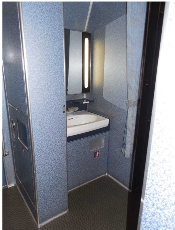
小田急電鉄30000形「EXE」の 8号車の洗面所 幅が狭く洗面器の下に蹴り込み空間も無い ため車いすでの利用には不便
