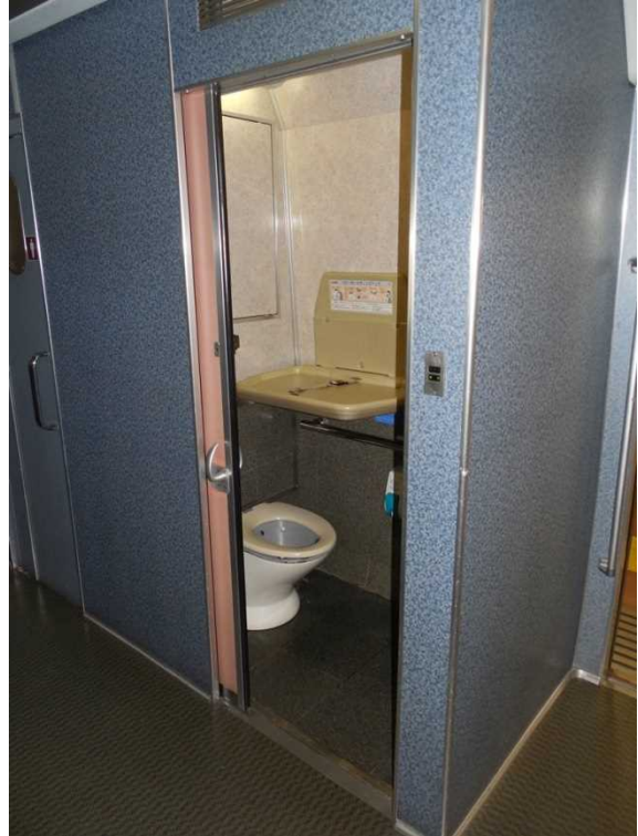
小田急電鉄30000形「EXE」の 8号車のトイレ 車いすのまま入れる広さは無い
