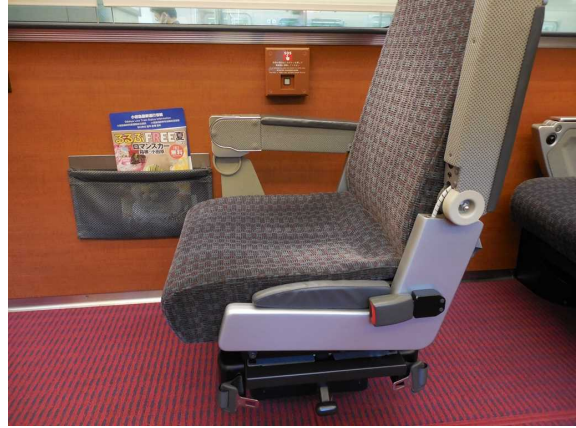
小田急電鉄6000形「MSE」の 5号車2番D席の車いす固定ベルト 肘掛けの上には非常通報装置が見えている
