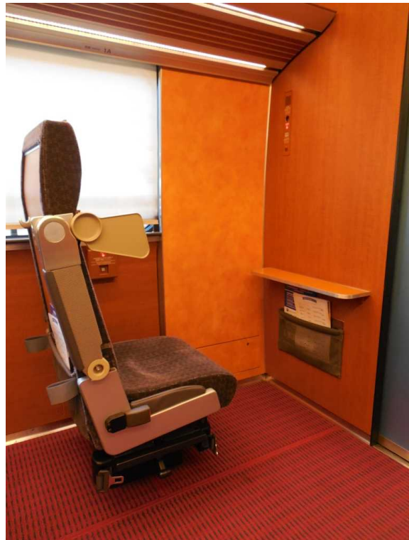
小田急電鉄6000形「MSE」の 8号車1番A席の車いす対応座席 前の壁には非常通話装置が見えているが 車いすの人には手が届かない高さ 車いすの人は窓の下に見えている 非常通報ボタンを使うしかない
