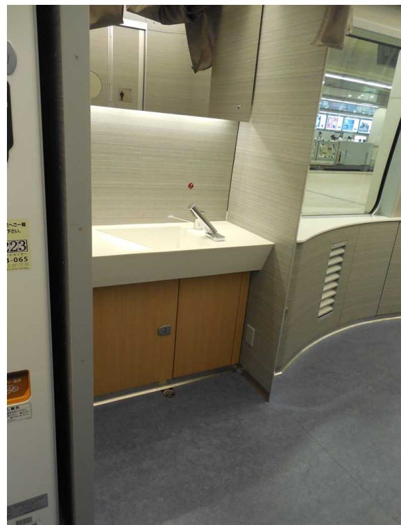
小田急電鉄70000形「GSE」の 車いす対応洗面所
