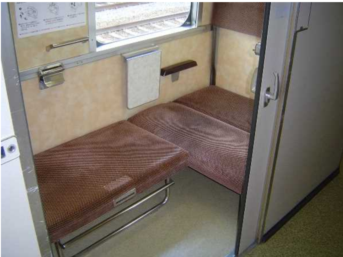
腰掛の座面と背ずりを引き出し、折りたたみイスを下げ、簡易ベッドを構成した状態。 寝たきりの人の乗車や急病人の休憩には、この状態に対応
