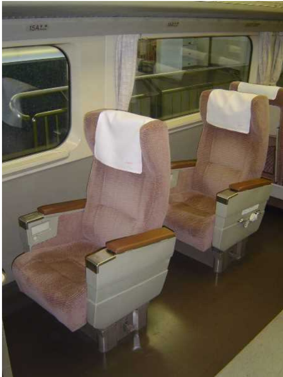
100系の車いす対応座席 車いす緊締用ロープがあるのは 奥の14番A席のみ
