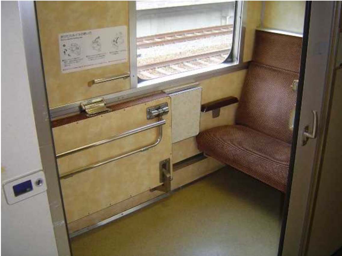
折りたたみイスを跳ね上げた通常の状態。車いすのまま入れる広さが確保されている
