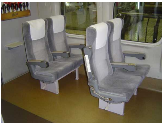
300系11号車の車いす対応座席 車いす対応設備があるのは 右側の12番A B席のみ
