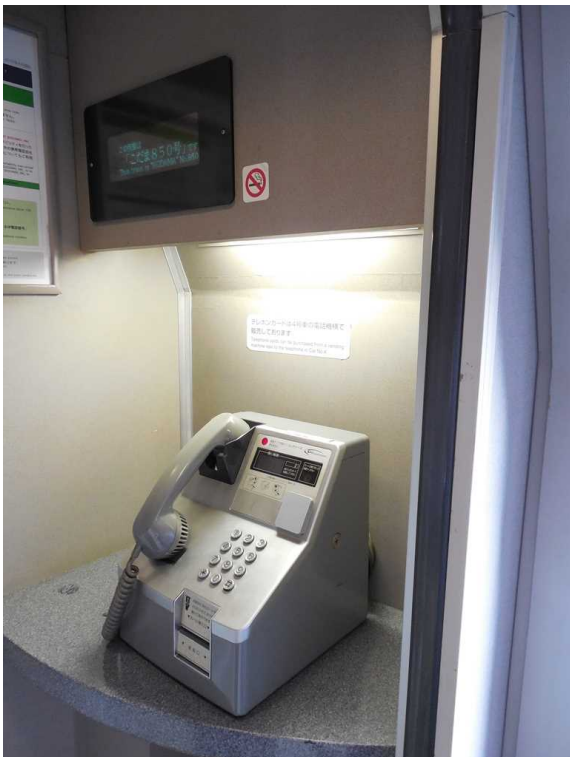
500系8号車の電話機の上に設置されている列車名表示器 かつて地上から乗客へ電話をかけることができた時代に、呼び出された乗客は 交換手へ列車名を伝える必要があり、そのために設置されていた
