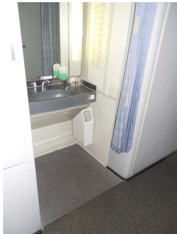
500系7号車の車いす対応洗面所
