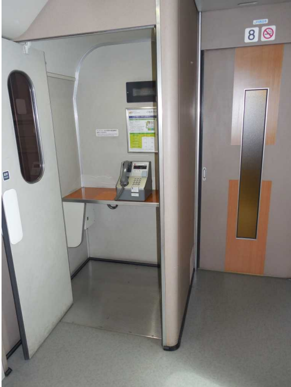
700系（レールスター編成）8号車の 車いす対応電話室 電話機の上部の壁に列車名表示器が 設置されている
