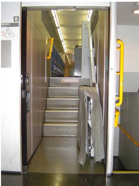
E 1 系 8 号 車 の 車いす昇降装置を デッキから見たところ
