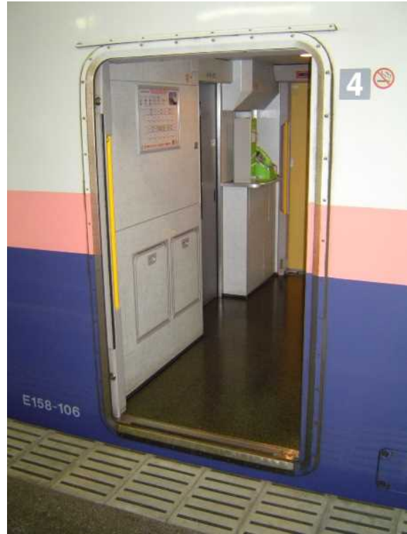
E 1系 4号車の公衆電話（車いす非対応） 手前の壁にはジャンプシート （跳ね上げ式補助席）が2席見える
