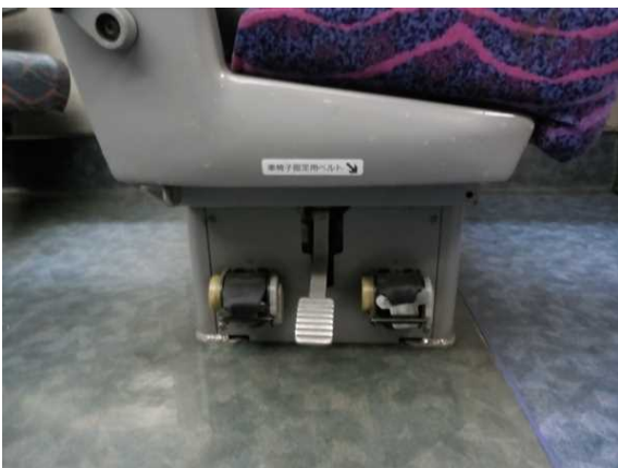
E 2 系 1 0 号車 (普通車) の 車いす固定ベルト
