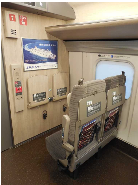
E 5 系 5 号車 ( 普通車 ) の 車いす対応座席と非常通話装置
