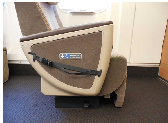
グリーン車の車いす固定ベルト
