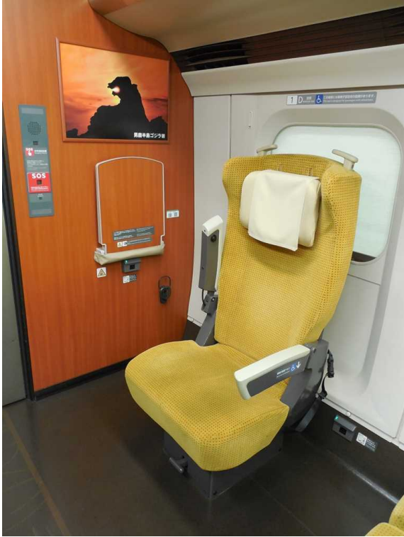
E 6 系 1 2 号車 (普通車) の 車いす対応座席と非常通話装置 肘掛けは左右両方とも跳ね上げ可能
