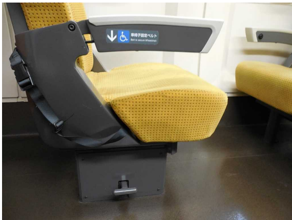
E 6 系 1 2 号車 (普通車) の 車いす固定ベルト
