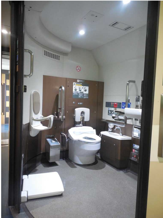
E 6 系 1 2 号 車 の 多 機 能 トイ レ 天 井 に は 喫 煙 防 止 用 の 火 災 報 知 器
