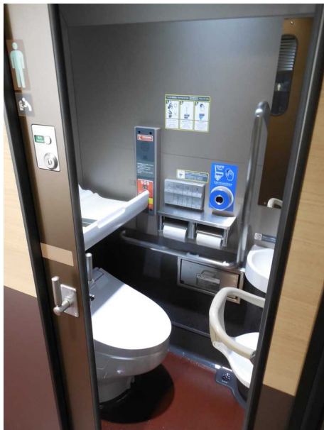
E 8 系 の 1 6 号 車 の ト イ レ 窮 屈 な レ イ ア ウ ト な が ら ベ ビー チェア と ベ ビー ベ ッ ド が 設 置 さ れ て い る 14 号 車 と 15 号 車 の ト イ レ も 同 じ 構 造
