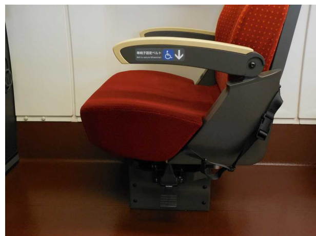
E 8 系の普通車の車いす固定ベルト 自動車のシートベルトと同じ作り
