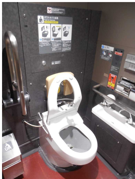
E 8 系のオストメイト対応設備 便器の中央にスパウト（水洗用具）を 引き出した状態
