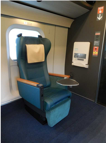
E 8 系のグリーン車の車いす対応座席 この D 席には車いす固定ベルトが無い 右端の壁に非常通話装置が見えている
