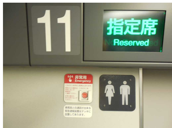
左の写真の非常停止ボタン部分 N700Aのみボタンの下に 「乗務員との通話ができる緊急通報装置は デッキに設置してあります」との案内が 追加されている
