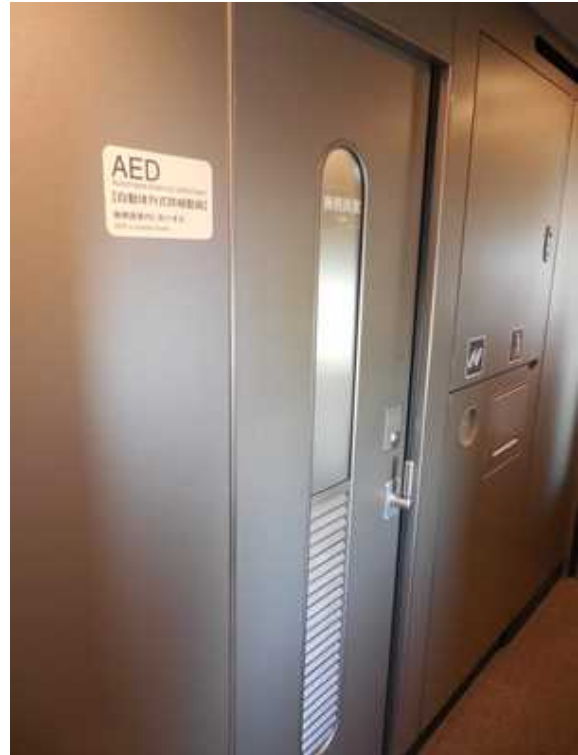
N700A 8号車の車掌室内に AEDが備え付けてあることの案内掲示 車掌が車内巡回中で施錠されていると すぐには使えない可能性がある
