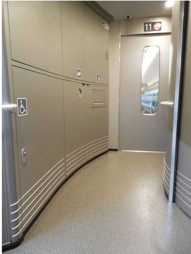
N700Aの11号車の バギー（車内専用車いす）格納庫 （左奥の車いすマークの部分）
