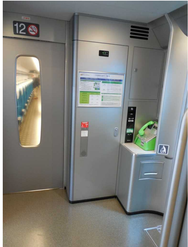
N700Aの12号車の 車いす対応公衆電話（現存せず） 電話機の左に見える対話式緊急通報装置は 車いすでも使用可能な低さに設置
