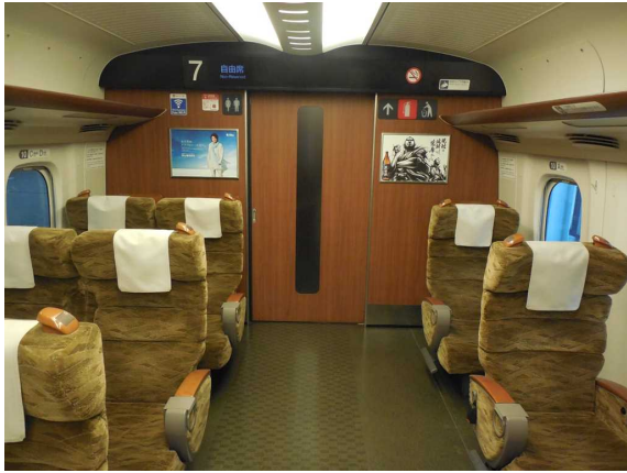
N700系7000代の車いす対応座席（右下）と非常ボタン（左上）との位置関係 非常用ボタンは号車番号表示の下にあるため車いすの人は手が届かない
