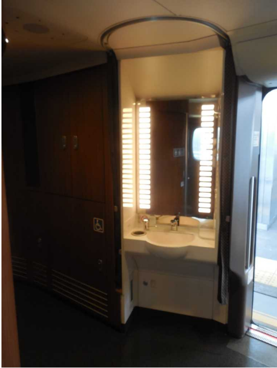
N700系8000代の車いす対応洗面所 左下には車内専用の車いす（バギー）の 格納庫がある
