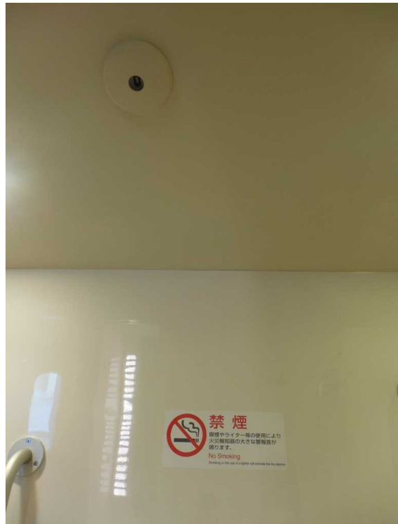
N700系8000代の多機能トイレ内の 喫煙防止装置
