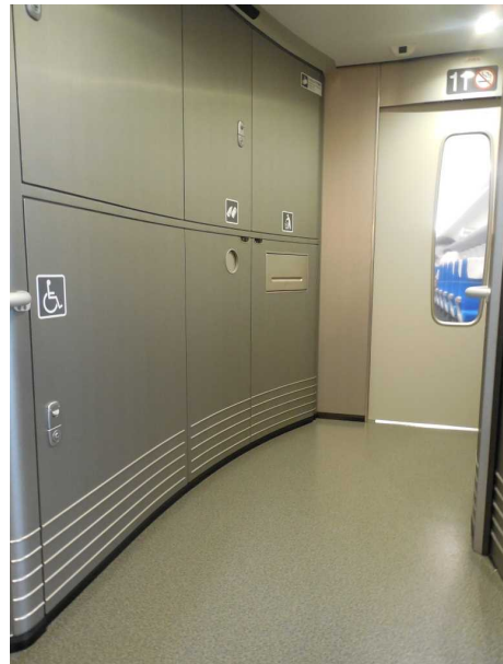
N700Sのバギー格納庫(左) バギーとは車内専用の小型の車いすのこと 画面右が多目的室
