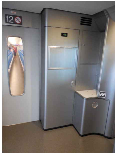
N700Sの12号車の公衆電話設置台 列車公衆電話の廃止が決まる前に 発注・製造されていた車両は 電話機を設置せずに就役した
