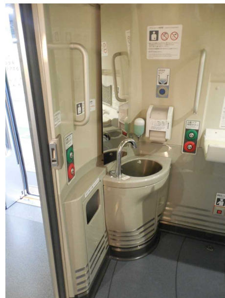
N700Sの多機能トイレ内の オストメイト用設備
