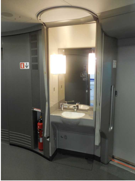
N700Sの11号車の 車いす対応洗面所
