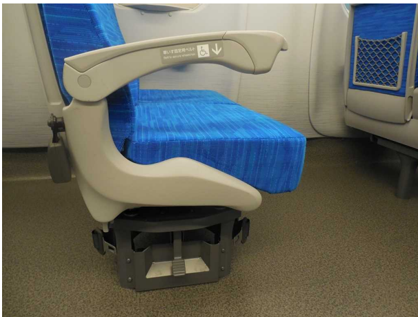
N700Sの1次車の車いす対応座席の 車いす固定用ベルト A B席のみ設置、D E席では省略
