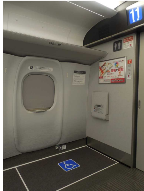
N700Sの11号車の 非常停止ボタンと非常通話装置 画面右上の号車表示の下に非常停止ボタン その下(広告の右)に非常通話装置 どちらも車いすでの利用は困難な高さ
