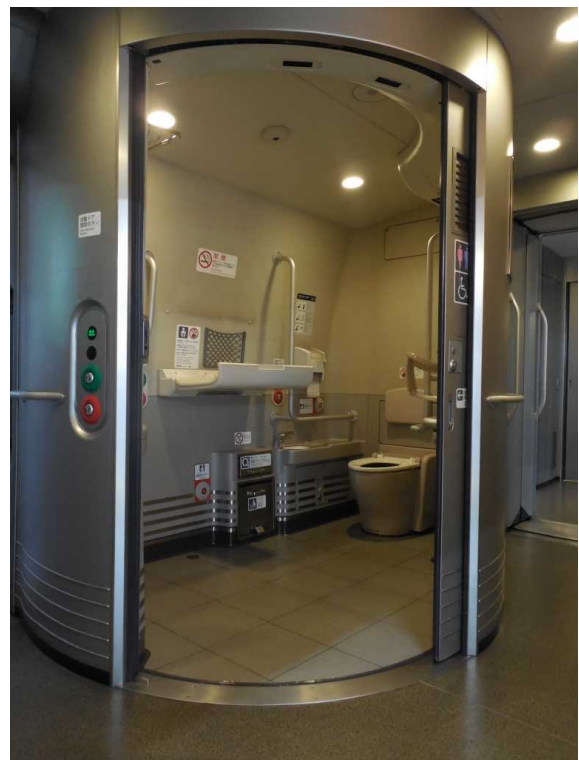
N700系の多機能トイレ 天井中央の丸い物が火災報知器
