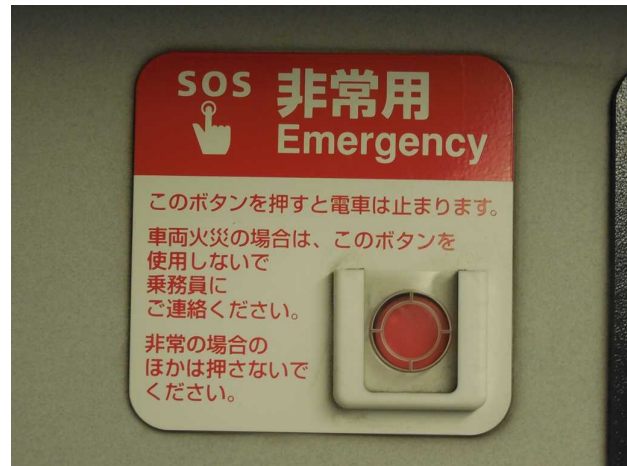
左の写真の非常停止ボタン
