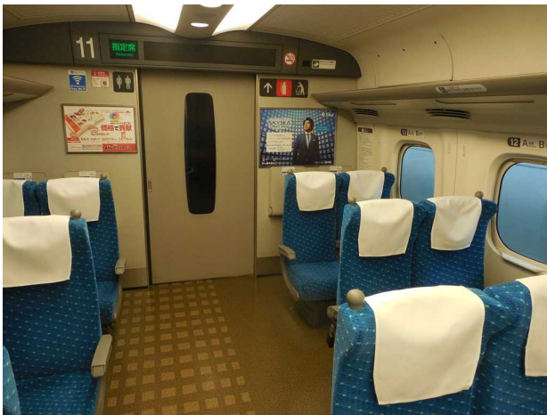
N700系11号車の 列車非常停止ボタン (左上の号車番号表示の下) 画面右下が車いす対応座席 車いすの人は手が届かない高さ
