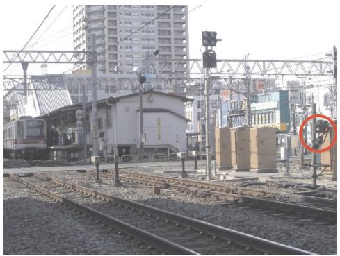
【写真2】第38号踏切の手前、引上線が上り緩行線と合流する 地点にある引上線第2入換信号機(赤丸内)。朝ラッシュ時に列車 間隔を詰めるため、閉そく区間(事故防止のため1つの区間には 1本の列車しか入れないシステム上の単位)を細かくするために 設置されている。この写真のように黄と赤の2つの灯火が水平に 並んでいるときは停止(進行不可)、2つとも黄色の灯火が左下と
