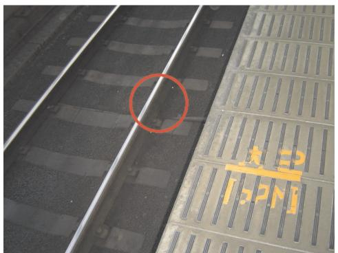
【写真3・4】北千住駅4番線ホームの浅草寄りに設置されている、伊勢崎線第22号踏切の警報開始用の踏切制御子(赤丸中の、針金がレールに溶接されたように見える部分)。列車の先頭がここを通過すると、第22号踏切の警報が鳴り始め遮断機が下りるよう設定されている。すなわち何両編成の列車であっても、所定の位置に停止する直前から第22号踏切の警報が鳴り始め、客の乗降時間が長引けば踏切遮断時間も延びることになる。
