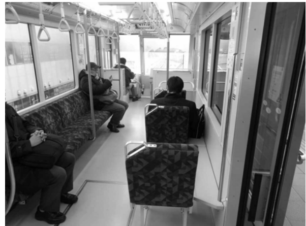
【写真1】日暮里・舎人ライナーの先頭車の車内。1人掛席の右側の荷物置場のような場所が、立席乗車面積調整用のデッドスペース。
