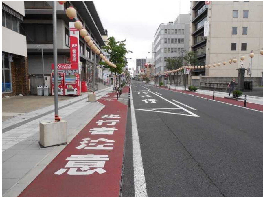
【北行13】中央郵便局前バス停で自転車道が屈折している様子・その1。路面に「歩行者注意」と大書されている。
