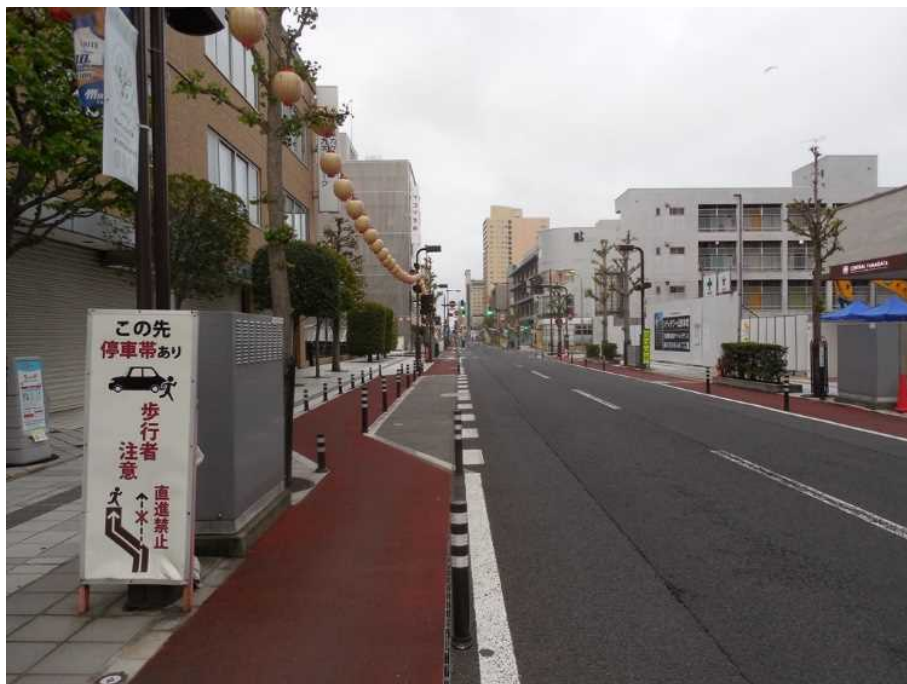
【南行16】東北電力ビル付近の自動車停車帯で自転車道が屈折している様子。
