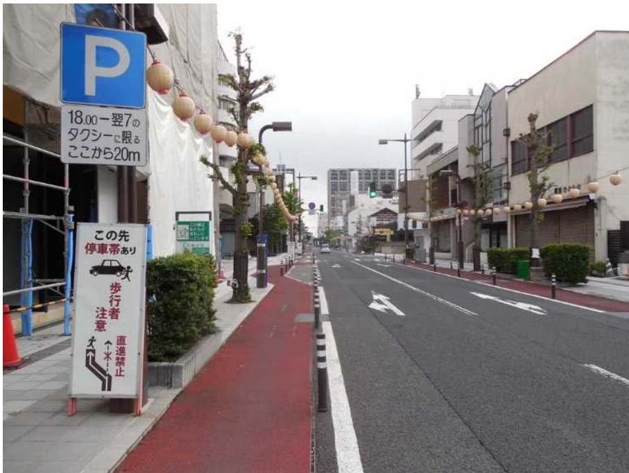
【北行16】荘内銀行山形ビル前の自動車停車帯で自転車道が屈折している様子・その1。左手前にそのことの予告看板が設置されている。
