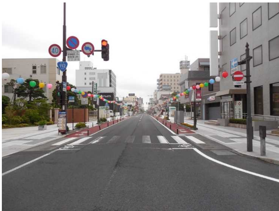
【北行2】十日町交差点から北へ向かう国道112号線の標識類。自動車は南から北への一方通行だが、画面左に北行の自転車道が、右に南行の自転車道が、それぞれ設置されている。
