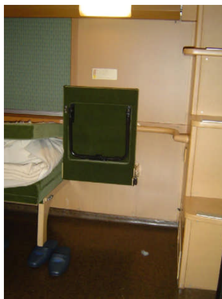
【写真】 285系「サンライズエクスプレス」の車いす対応個室寝台のベッドの一部を跳ね上げ、車いすが入れるスペースを作った状態。(【写真】と同じサハネ285-202で撮影)
