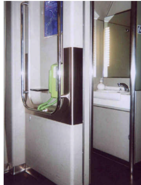
【写真】JR西日本「しらさぎ」用683系号車の車いす対応座席最寄りデッキの洗面所と公衆電話。電話を車いす対応構造としている一方で、洗面所は車いすでは利用できない狭い構造と、バリアフリーへの配慮に一貫性がない車両設計が行われている。（2003年製造のサハ682-2210（S10編成）で撮影）
