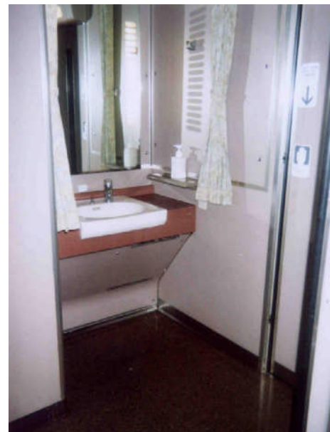
【写真】JR東海・JR西日本285系「サンライズエクスプレス」 号車の車いす対応洗面所。間口が広く、足元に蹴り込み用の空間が確保されている。（1998年製造のサハネ285-202（JR西日本保有I2編成）で撮影）
