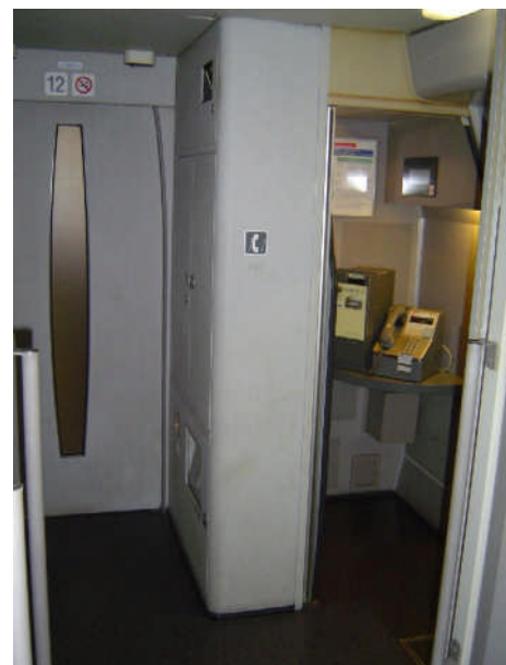
【写真】東海道・山陽新幹線500系号車の電話室。他の号車の電話室に比べて間口が広く、電話機設置台の位置（高さ）が低い。（1997年製造の527-702（W2編成）で撮影）
