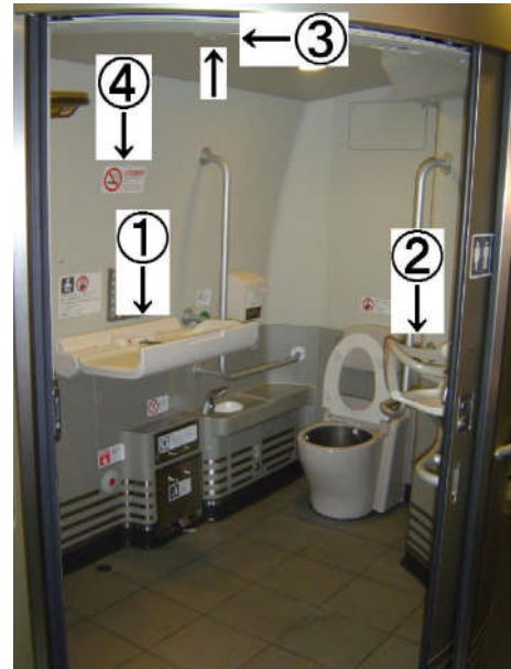
【写真】東海道・山陽新幹線N700系 号車の車いす対応トイレ。ベビーベッド（矢印 ）とベビーチェア（矢印 ）をセットした状態。オストメイト用設備はベビーベッドの左側にある。喫煙すると火災報知器（矢印 ）が作動する旨の注意書き（矢印 ）も見える。（2007年製造の786-3703（JR西日本保有N3編成）で撮影）
