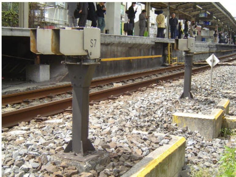
【写真】 「東上本線第22号踏切」に設置されている踏切支障報知装置。
